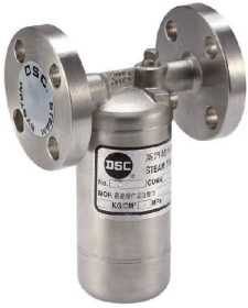
S.S IB STEAM TRAP No : 701F~706F CONN.FE:1/2"~2" MAX:9,000KG/HR 28KG/CM 2
